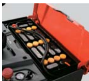
高性能的3PzS(4PzS) DIN标准电瓶，适合长时间操作
